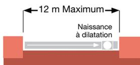
Si l'installation se présente telle que fig. B "ligne bloquée aux deux extrémités ou à l'opposé de la descente" et n'excède pas 12 m, il y aura lieu d'utiliser une naissance à dilatation.
